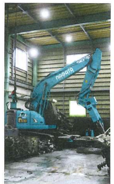
永田プロダクツの本社工場で10年以上愛用されている有線電動式の自動車解体専用機。油やアドブルー等が不要で固定費が抑えられる上に、「消耗部の摩耗はあるが故障したことがない」(永田則男社長)という。
